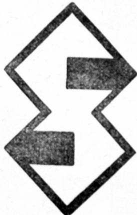
(257) Návěstí 78 „Sběrač dolů“ se označuje začátek traťového úseku, jenž má být projížděn se staženými sběrači, nebo konec traťového vedení, není-li totožný s koncem příslušné kolejí.
